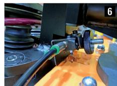
De demontage- en montagehandelingen kunnen ook worden verricht met gebruik van de bankschroef voor pneumatische veerspanners. De bankschroef moet op de pneumatische veerspanner worden geplaatst door de pinnen in de hiervoor bestemde openingen te steken. Zet de stang van de schokdemper in de bankschroef vast en ga over tot de demontage- en hermontagewerkzaamheden.
