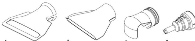
**!** Beim Gebrauch des Zubehörteils D sicherstellen, dass der aus den seitlichen Entlüftern austretende Fluss keine Personen verletzen oder Gegenstände beschädigen kann.
